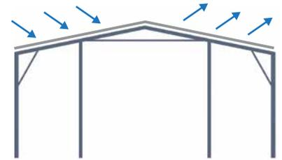
• Nave sin paredes y únicamente cubierta de techo
